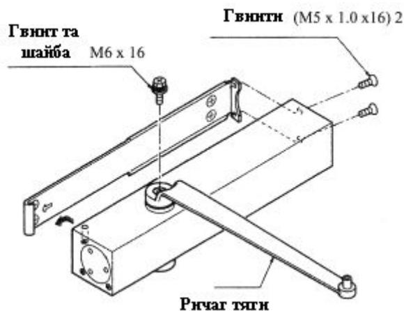
4. З'єднати тягу з ричагом тяги, та закріпити гвинтом з шайбою M5x12, і надіти декоративну кришку на шток.
